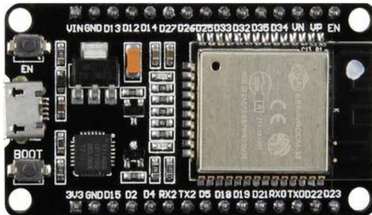
Cette carte assez puissante est équipée d'un calculateur double cœur 32bits, d'une interface wifi et bluetooth, ainsi que diverses interfaces analogiques, digitales et de communication type I2C, UART, etc... Cette carte est alimentée en 5V ou plus et possède un régulateur 3,3V pour son fonctionnement interne.
