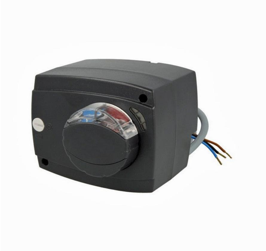
Pour actionner la vanne 4 voies de mon installation, j'utilise un moteur bidirectionnel qui fonctionne en 240V. Ce moteur comporte des butées de fin de course qui limite la manœuvre de la vanne à  $\frac{1}{4}$  de tour. Il se fixe sur l'axe de la vanne par un adaptateur. Le temps d'activation de butée en butée est de 90 sec. Il n'y a pas de retour d'information sur la position de la vanne, il faudra donc que je pilote la position du moteur par une autre méthode.
