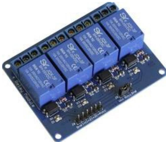
Cette carte relais est contrôlée par l'interface GPIO de l'ESP32 et fournit 4 relais repos/travail en 240V. J'utilise ces relais de la façon suivante :
