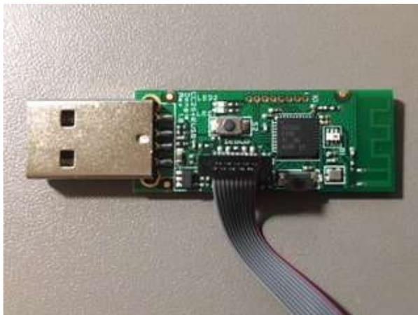
Branchez le CC Debugger et le Sniffer CC2531 sur l'ordinateur. La LED du Debugger va être rouge au branchement., Appuyez sur le bouton RESET pour la passer en vert. On est prêt pour flasher le firmware.
