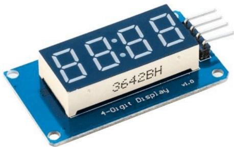
Le module display utilise un circuit de contrôle TM1637. Il s'agit d'un composant spécialement conçu pour la gestion des afficheurs à LED.
